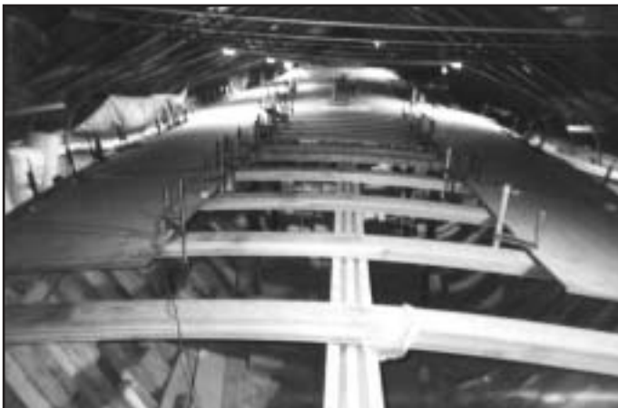
Barque des Enfants : la pose du pont de mélèze en 1998 à Vevey. Photo Christian Reymond
